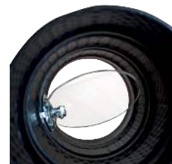
Abb. 20 Absperrklap- pe für den Flex-Arm um die Gleichzeitig- keit zu regulieren.
