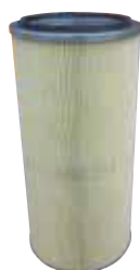
Patronenfilter Feinfiltration durch selbst-reinigende Filterpatronen erhöht Intervall zw. den erforderlichen Filterwechseln. (Normale Lebenszeit 2000-6000 Stunden.)
